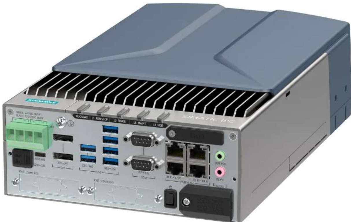
SIMATIC IPC BX-59A con processore da 65W e dissipazione attiva
